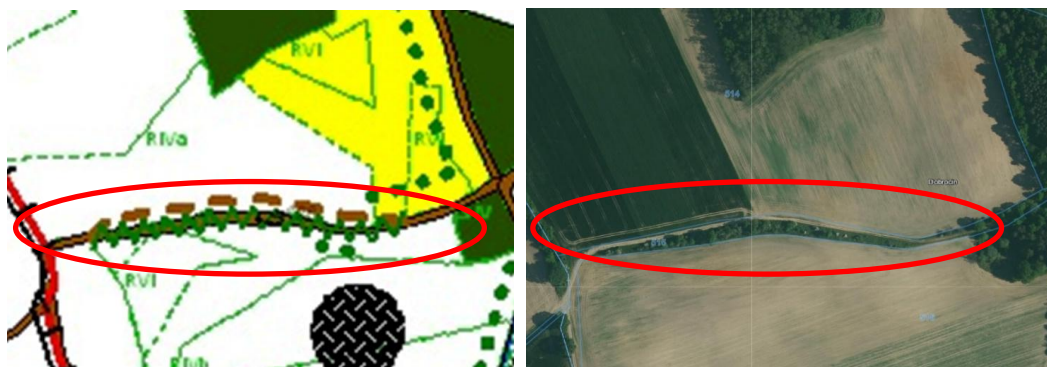
Ilustracja 13. Projektowanie sieci drogowej z uwzględnieniem istniejących elementów środowiska w ramach scalenia gruntów 20 – przykład obiektu Dobrocin (gm. Dzierżonów, woj. dolnośląskie)
