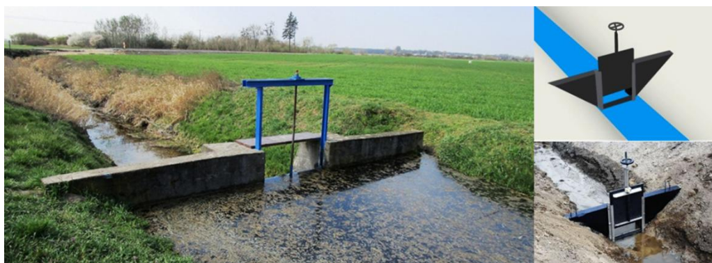
Ilustracja 70. Zastawka piętrząca typu dokowego Źródło: Opracowanie własne
