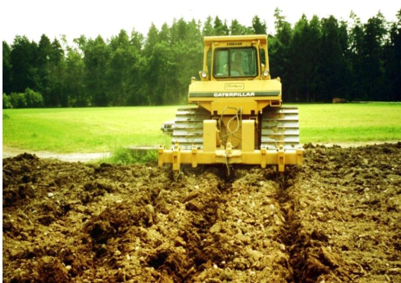
Ilustracja 24. Zwiększanie retencyjności gleby poprzez zabiegi agromelioracyjne – głęboszowanie
