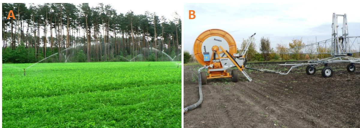
Ilustracja 27. Nawodnienia deszczownianic: A – deszczownia stała, B – deszczownia szpulowa
