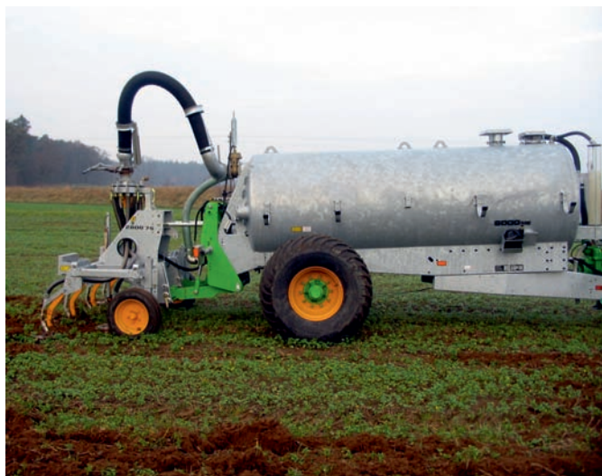
Fot. 2.12. Aplikacja płynnych nawozów naturalnych za pomocą aplikatorów doglebowych (fot. T. Piechota)
