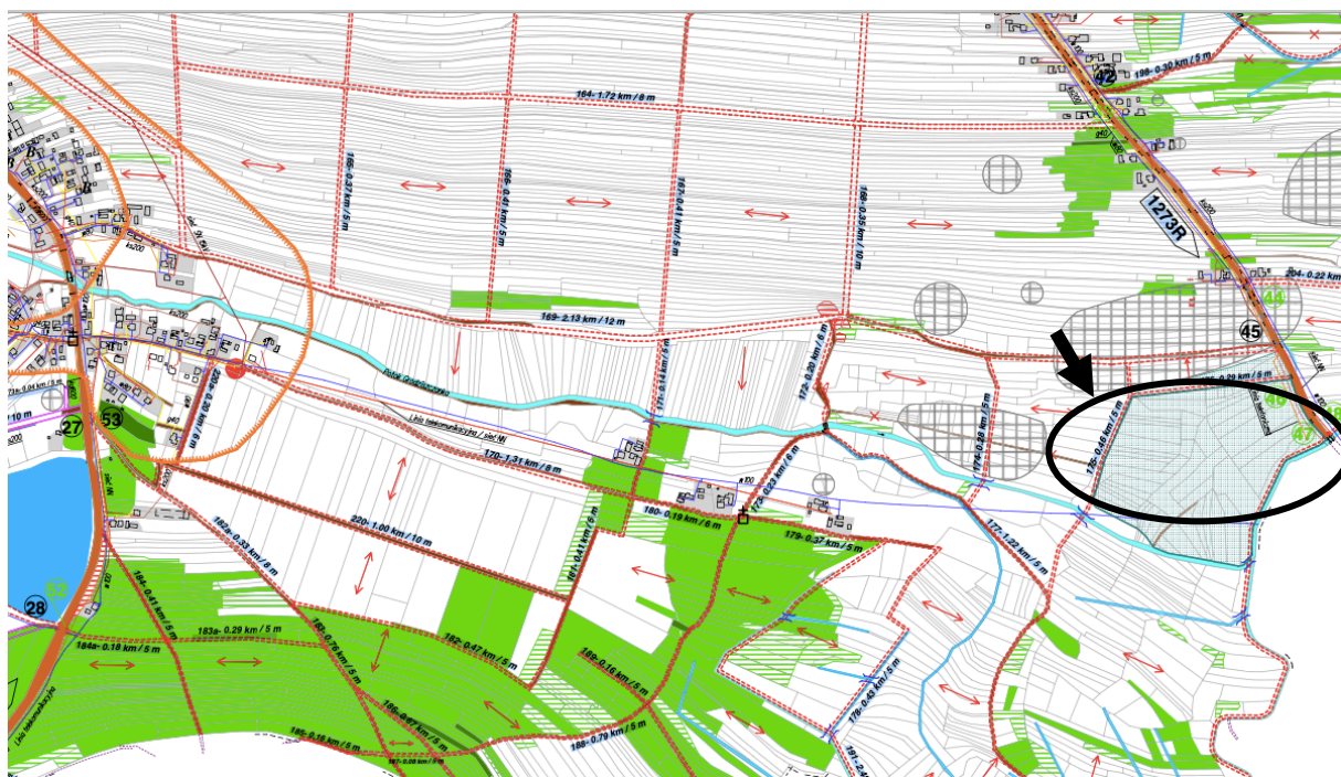
Rys. 4.9. Planowana lokalizacja zbiorników wodnych małej retencji (Założenia do projektu scalenia gruntów wsi Grodzisko Dolne, gm. Grodzisko Dolne, pow. leżajski, woj. podkarpackie, cz. graficzna, PBGiTR, Rzeszów 2015)
